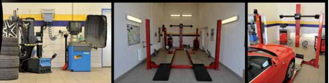
Stroj S300 - automatická hydraulická sezouvačka nízkoprofilových a run-flat pneumatik, umožňující bezpečné upínání disků za středový otvor. Hunter - Měřicí středisko HUNTER engineering company se senzory HawkEye používají vícerozměrné modelování s cílem poskytnout přesné měření a seřízení geometrie
