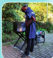
SVAŘUJE NA ELEKTROCENTRÁLE 3,5 KVA
